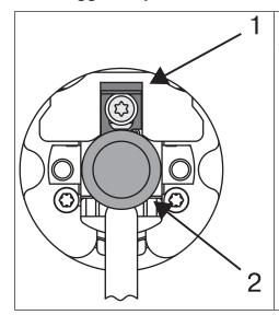
Il perno (2) si blocca automaticamente quando inserito. Per smontare il perno (2), spingere verso l'alto la placchetta di sicurezza (1) ed estrarre il perno (2).
